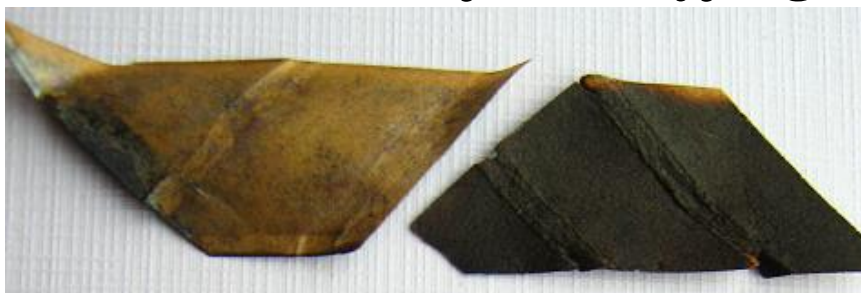
Widok materiałów po próbie wg normy PN-EN 62535:2009 w obecności oleju korozyjnego
