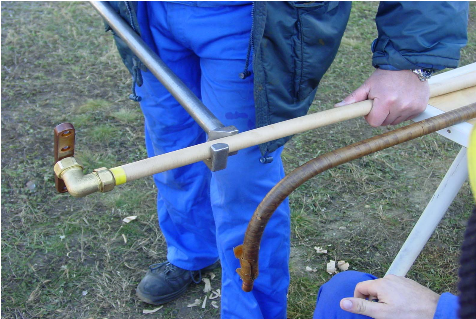
Új OLTC bekötő vezeték helyszíni „gyártása” MR szakértő által
